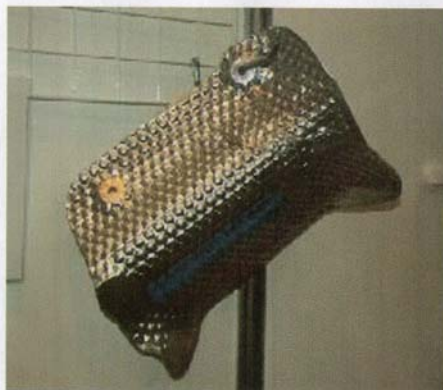
図4 スズキ「スイフト」用のエンボス板
