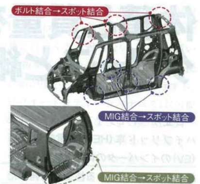
図5 各部の結合法の変化 ボルト結合やMIG結合を、スポット結合にできた。
